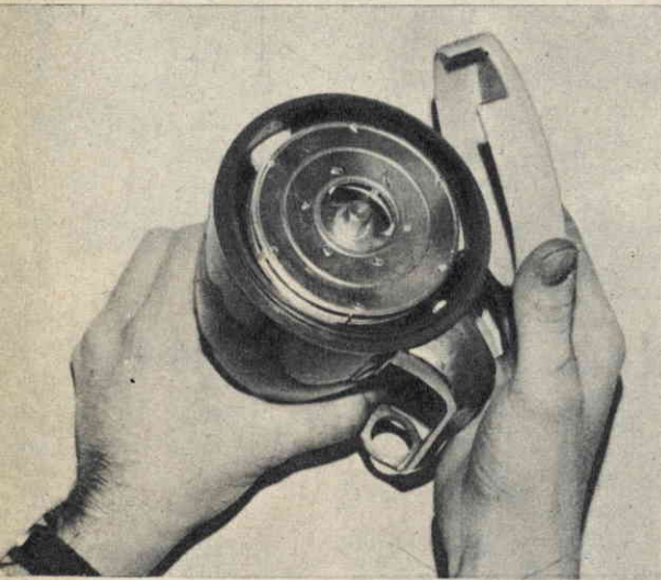
Fig. 10 - Il coperchio di moplen chiude le parti contenute nella calotta posteriore.
