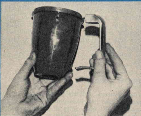
Fig. 2 - Il manico, cioè la prima impugnatura dell'aspiretta, costituisce il componente che si dovrà applicare per primo, mediante tre dadi, alla calotta posteriore.
